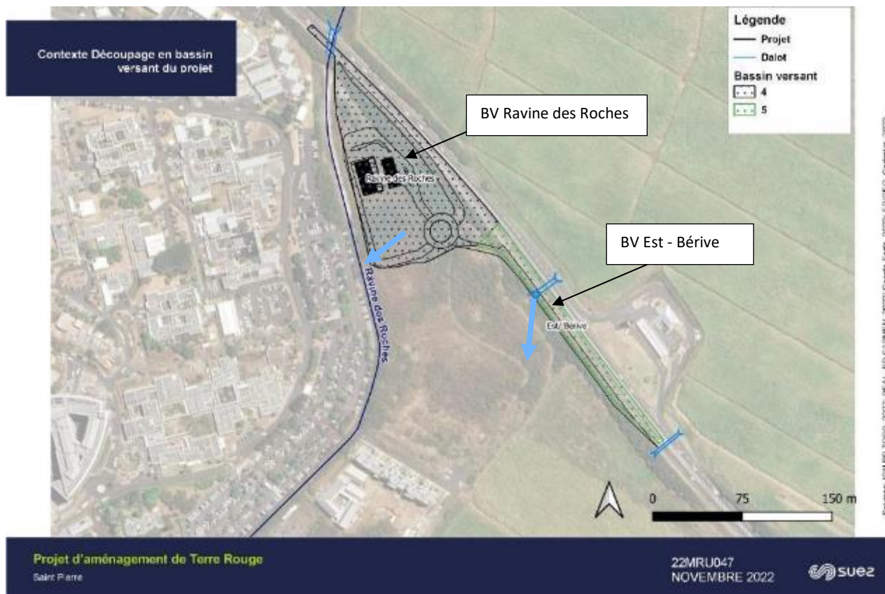
Figure 19: Découpage BV échelle projet - état initial
